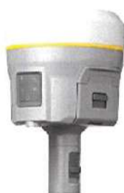
GNSS 受信機(QZSS・Galileo 対応 TrimbleR10/Net R9)
