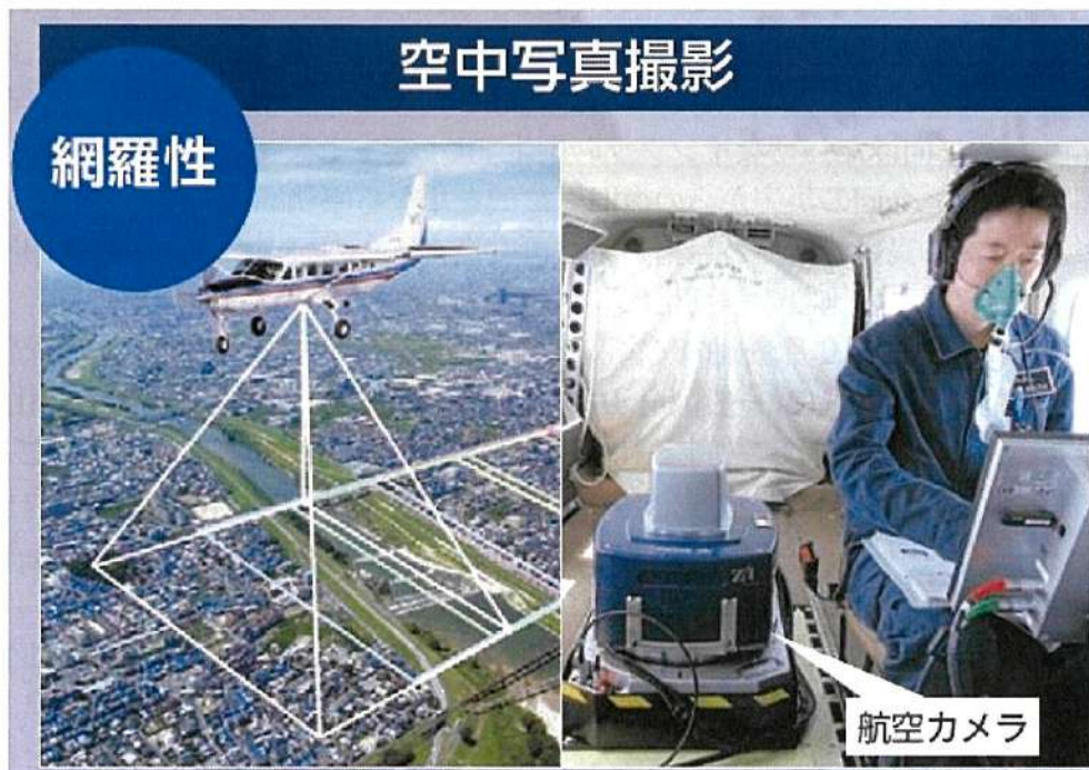
測量用航空機(くにかぜⅢ)による空中写真撮影のイメージ(左)と搭載中の航空カメラ(右)
