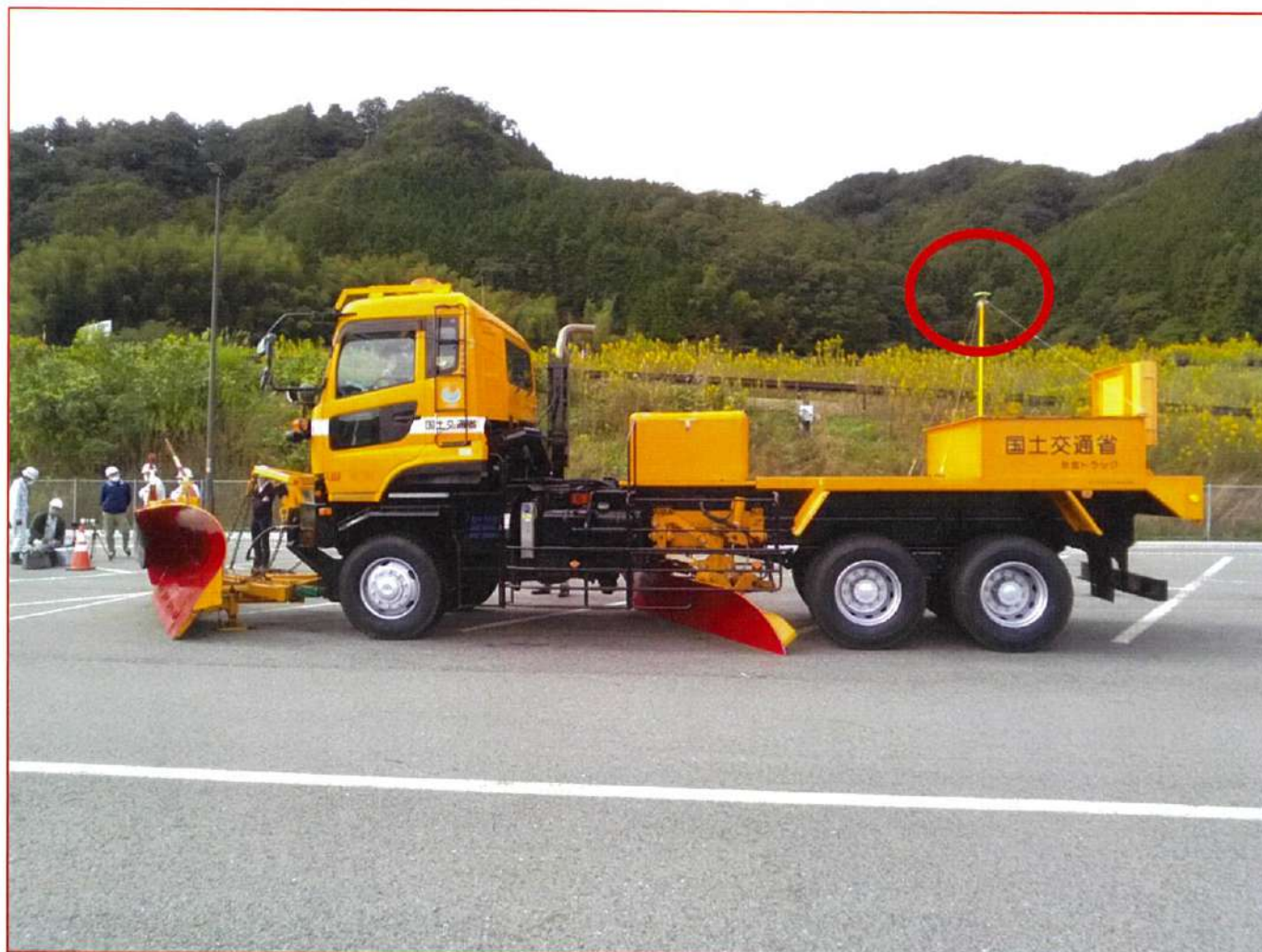
図4 機械除雪用車両（提供：国土交通省中国地方整備局三次河川国道事務所） （○印は衛星測位用受信アンテナ）
