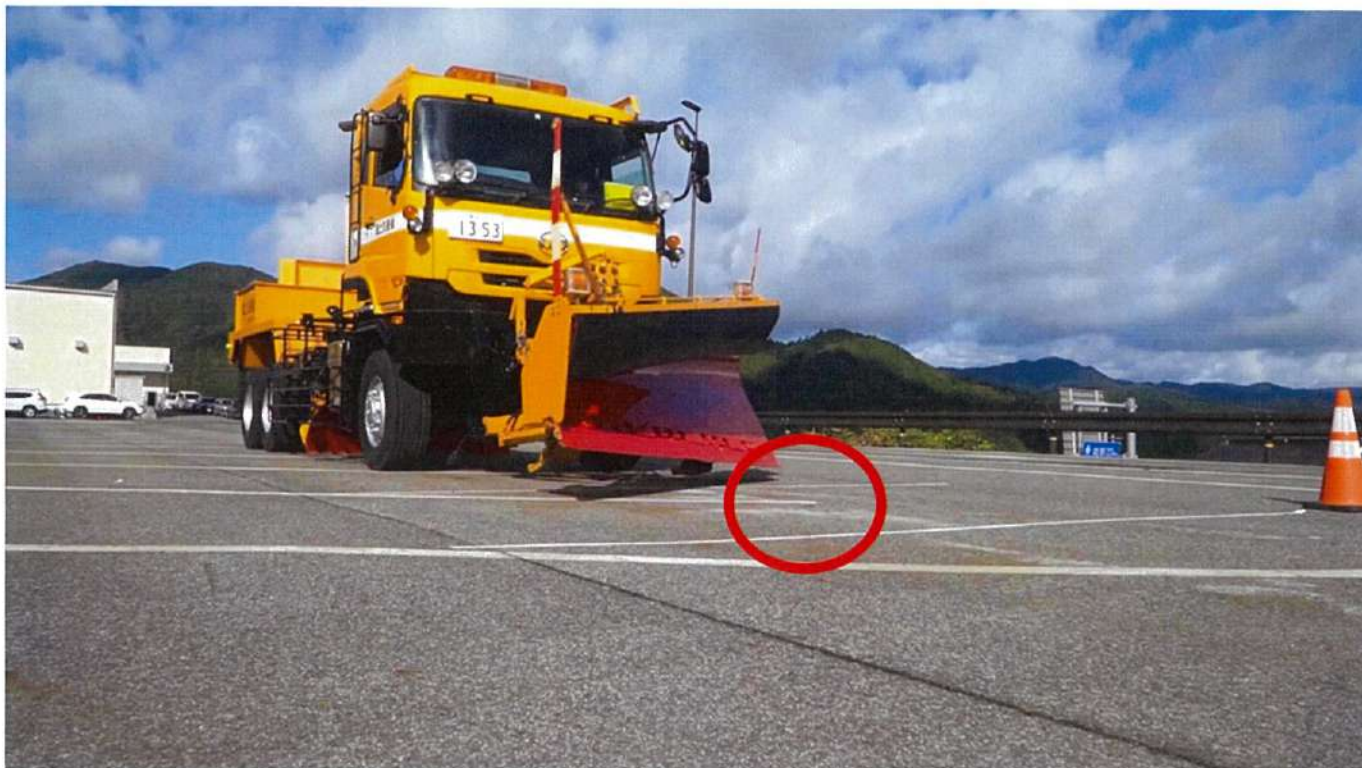
図5 実証実験の対象地（国土交通省中国地方整備局三次河川国道事務所口和除雪車両基地） （○印は障害物を想定したターゲットポイントでプラウが上昇している）
